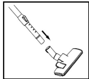
Четката за под има две настройки. При почистване на твърди повърхности (паркет, подови плочки и др.) дюзите трябва да бъдат удължени. При почистване на килими и изтряивалки четките трябва да са прибрани в накрайника. Натиснете бутона за смяна на четката, за да превключите между двете настройки.
