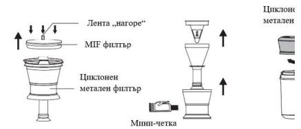
1. Дръжте циклонния филтър в едната си рък стиснете логото „UP“ с другата ръка и извадете филтъра. Не потупвайте филтъра от обратната страна в случай на запушване на филтъра. Почистете металния циклонен филтър и пластмасовите части с приложената миничетка.
